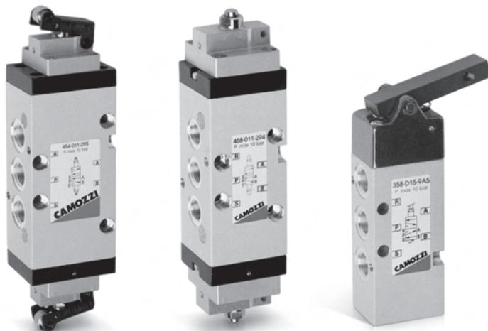
Сенсорные распределители с механическим управлением, Серия 3 и Серия 4, используются как конечные путевые выключатели в тех случаях, когда требуются низкие усилия срабатывания и большие расходы сжатого воздуха.
