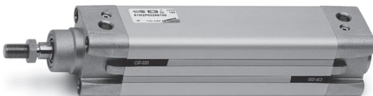
Цилиндры Серии 61 с диаметрами 32, 40, 50, 63, 80, 100 и 125 соответствуют стандарту DIN/ISO 6431. Гильза из экструдированного алюминиевого профиля имеет два продольных Т-образных паза (на трех сторонах) для размещения магнитных датчиков. Это позволяет сохранить те же самые установочные габариты цилиндра. Шпильки расположены внутри гильзы, что улучшает внешний вид цилиндра.
