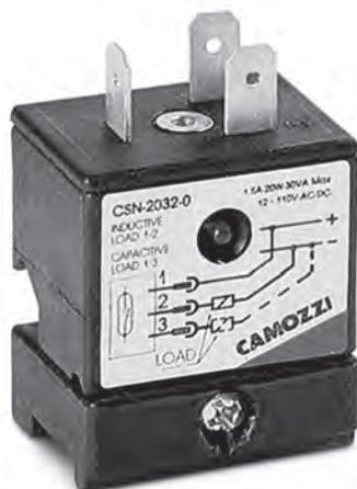
Магнитные датчики положения модели CSN 2032-0 состоят из геркона, дополненного схемой электронной защиты, светодиодной индикацией красного цвета и изолированным герметичным корпусом.
