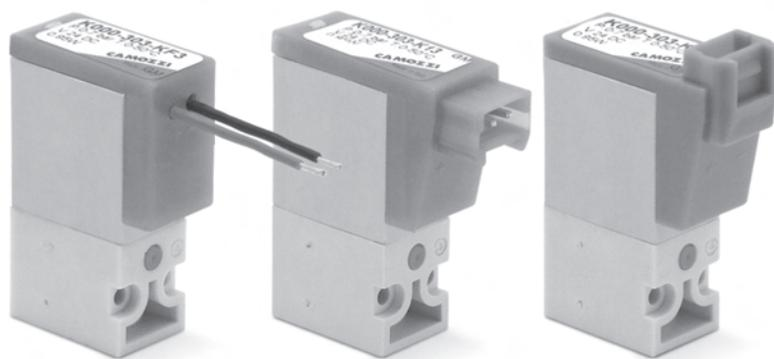
Электропневматические распределители прямого действия Серии К могут работать на воздухе как с распыленным маслом, так и без масла. Они поставляются 3/2 лин./поз. (Н.З.) нормально закрытые или (Н.О.) нормально открытые. Монтажные плиты могут быть как односторонними, так и многосторонними. На эти плиты можно монтировать и нормально закрытые и нормально открытые клапаны (но для последних нужен специальный переходник).
