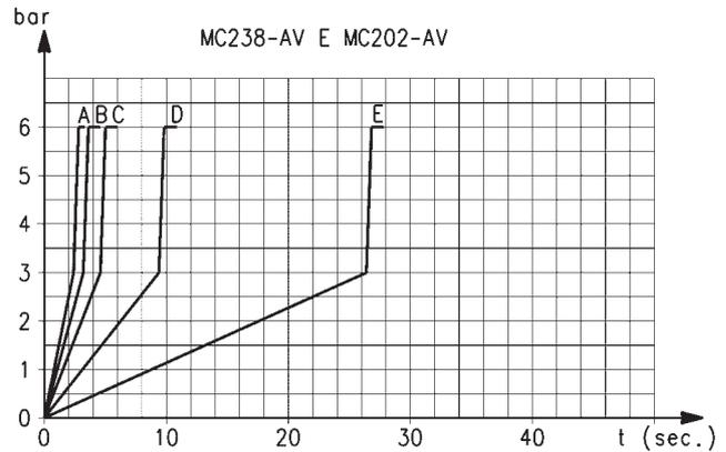
Константа К на графике показывает количество оборотов регулировочного винта для достижения требуемого времени нагнетания при входном давлении 6 бар. Разброс значений входного давления может вызвать изменение времени нагнетания на ± 20%.
