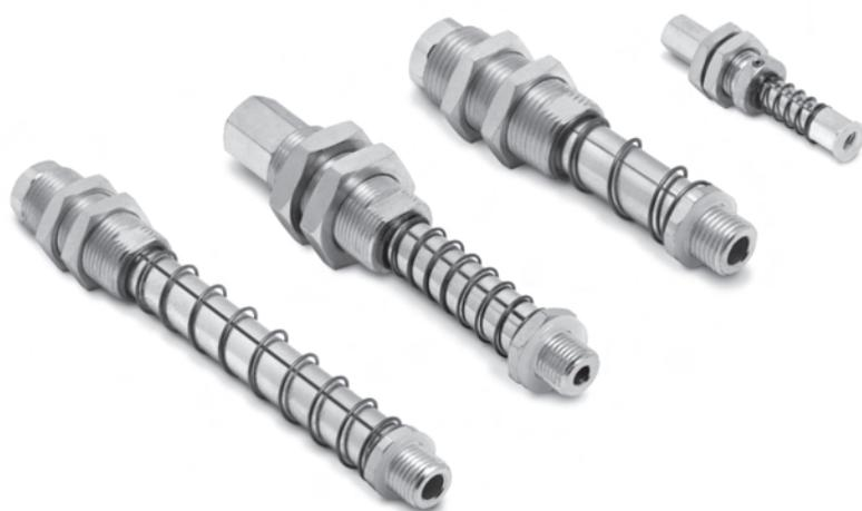
Пружинные плунжеры используются в случаях, когда необходимо компенсировать изменяющуюся высоту деталей. Пружина также обеспечивает мягкий прижим присоски к детали, исключая дальнейший контроль в полностью автоматизированных системах, что особенно важно при работе с хрупкими деталями.
