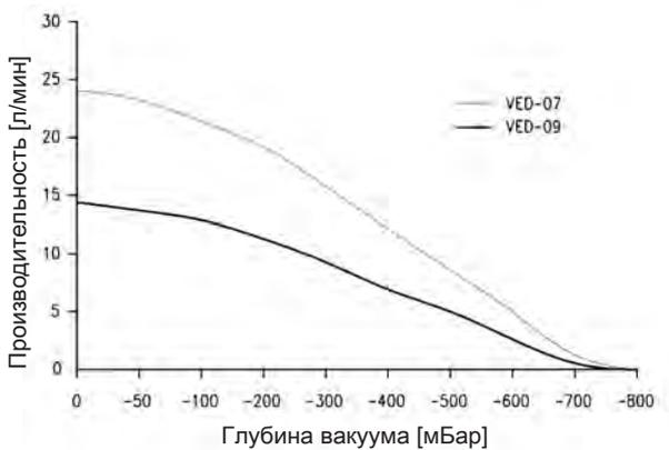
Зависимость производительности от глубины вакуума
