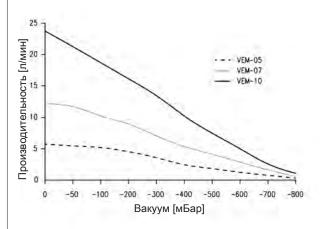
Зависимость производительности от глубины вакуума
